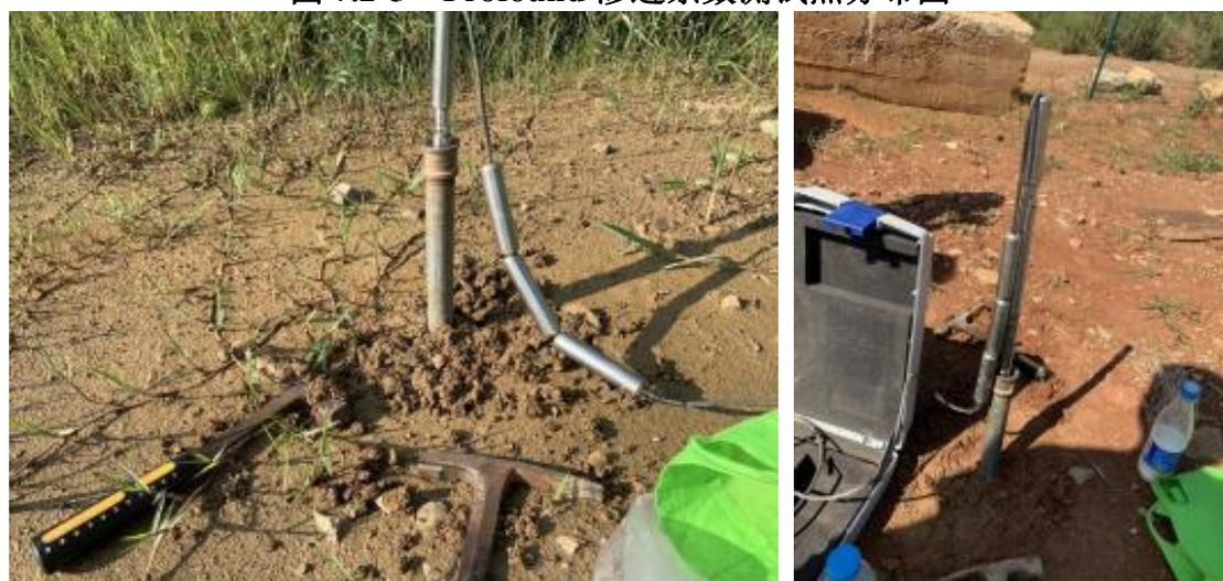
图 7.2-6 采区范围内不同地层包气带 K1 (左) 和 K2 (右) 渗透系数测试现场
